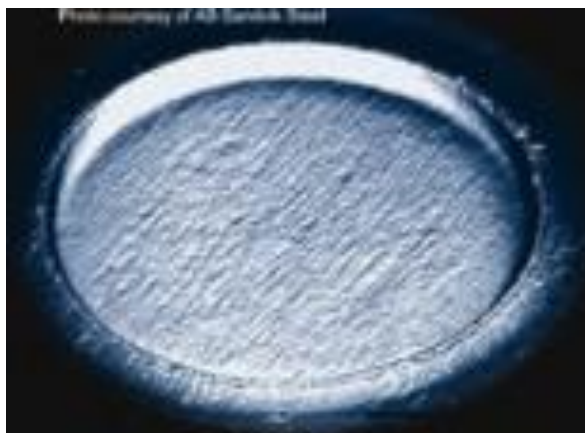
Rysunek 4. Prawidłowy kształt krateru powstałego w trakcie badania metodą GDOES [6]
