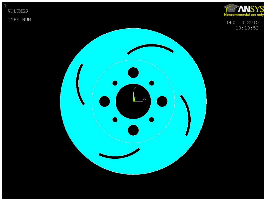
Rysunek 4. Geometria oraz wymiary analizowanej tarczy hamulcowej, widok z przodu Figure 4. The geometry and dimensions of analyzed brake disc, front view
