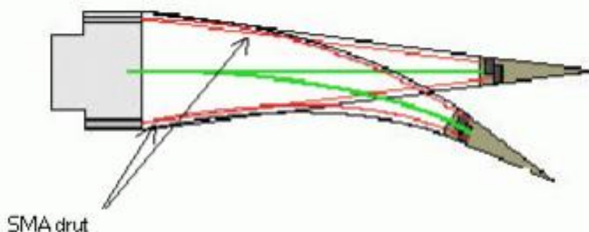
Rys. 3. Drut z materiału z pamięcią kształtu u z pamięcią kształtu [2]
