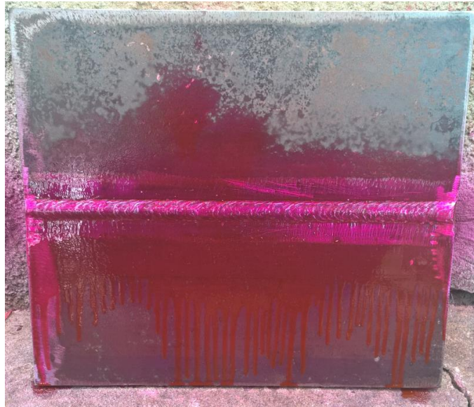
Rysunek 9. Płyta po naniesieniu penetranta Figure 9. Plate after penetrant application
