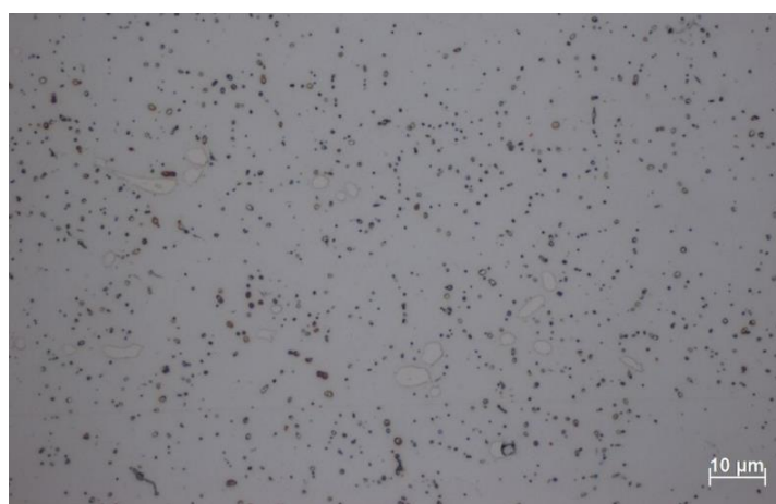
Rys 4. Stal K110 w stanie hartowanym i odpuszczonym. Pow. x1000, trawienie Murakami. Widok węglików wtórnych w osnowie wysoko odpuszczonego martenzytu.
