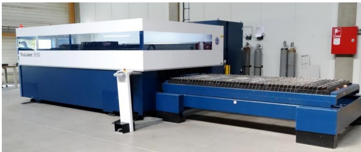
Rysunek 1. Wycinarka laserowa Trumf TruLaser 3030 [16]
