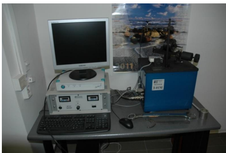
Rysunek 2. Stanowisko do badania właściwości tribologicznych materiałów, metodą pin-on-disc lub ball-on-disc
