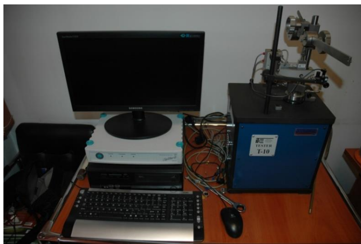
Rysunek 3. Stanowisko do badania właściwości tribologicznych materiałów, metodą ball-on-disc
