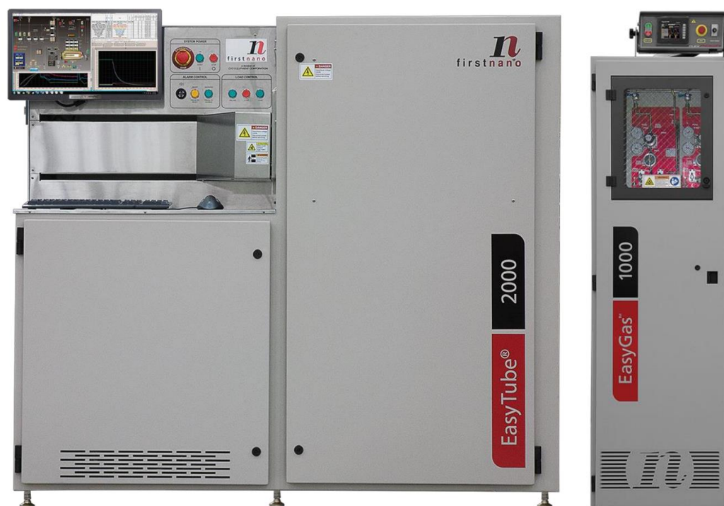
Rysunek 1. Urządzenie do wytwarzania nanorurek węglowych metodą pirolizy katalitycznej EasyTube 2000 [17]
