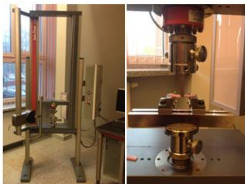
Rys. 2. Maszyna do badania wytrzymałości na zginanie Zwick/Roell Z020.
