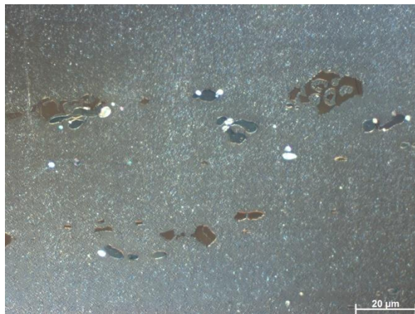
Rys.5. Mikrostruktura stopu aluminium 2017A; zgląd nietrawiony, mikroskop świetlny Figure 5. The microstructure of aluminum alloy 2017A;metallographic section undigested, light microscopy
